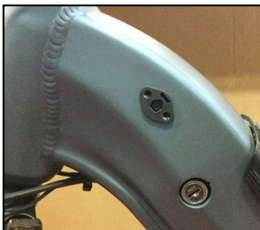
Figuur 19 – batterij aansluiting op het frame.
