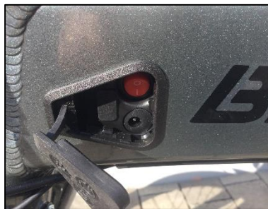
Figuur 10 – batterij aansluiting op het frame
